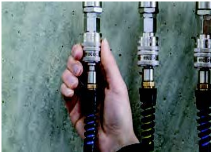
1. Duw de koppeling omhoog om te ontlichten.
